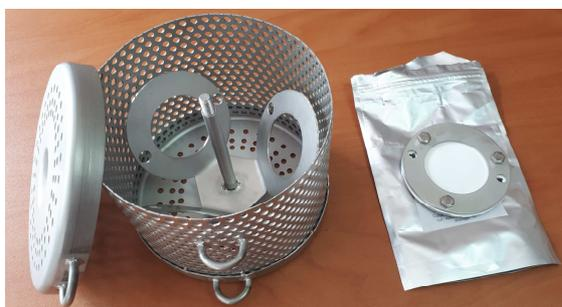
Figure 32 : Cage de protection et portoir à POCIS utilisés lors de l'étude terrain
