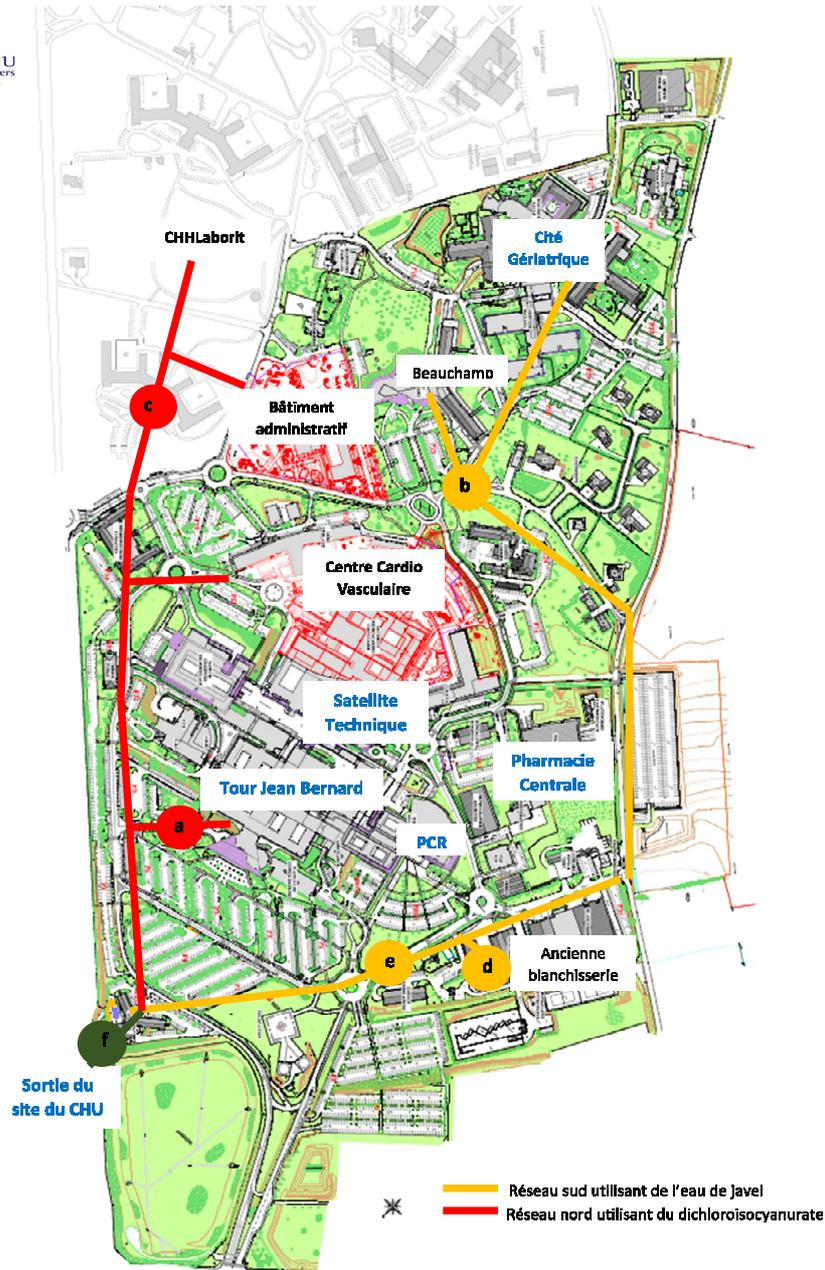
Figure 22 : Réseaux d'eaux usées et différents points de prélèvements considérés dans le cadre du projet BIOTECH au niveau du CHU de Poitiers
