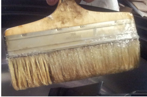
Figure 45: Exemple d'un outil en cours de lavage d'un produit enduit de vernis (seuls les premiers centimètres à gauche ont été rincés). Source: CNIDEP
