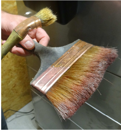
Figure 13: Exemple de résultats suite au lavage de deux outils dans la machine mise en test dans l'entreprise 1. Source: CNIDEP
