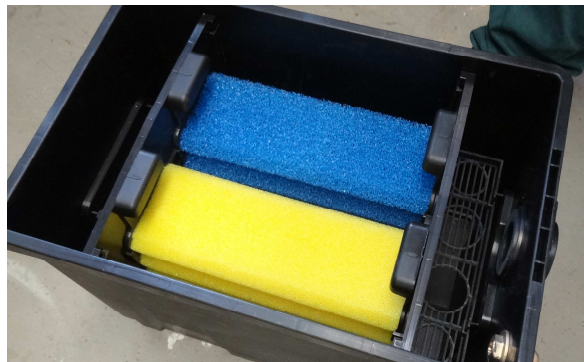
Figure 33: Unité de filtration rajoutée à la RCI 2.3 dans l'entreprise 3. Source : CNIDEP
