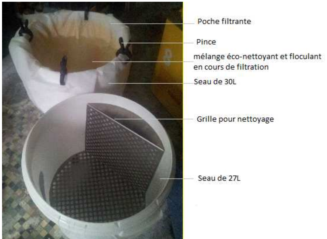
Figure 20: Photo de la machine de nettoyage des outils Adekit de ADEFY installée dans l'entreprise de menuiserie n°2 et identification des différents éléments. Source : CNIDEP
