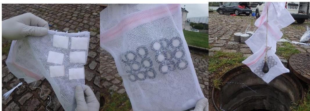
**Figure 5 : Filet en Nylon pour l'immersion des nouveaux outils sans obstruction des canalisations du réseau d'assainissement**
