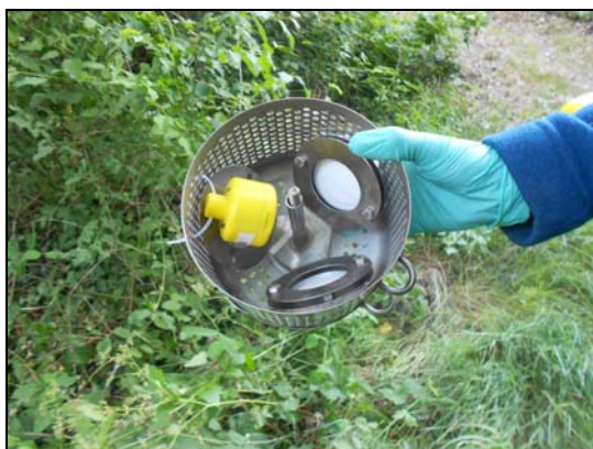
Figure 3 : Photos du système d'exposition des POCIS d'Irstea Bordeaux, un canister inox Exposmeter
