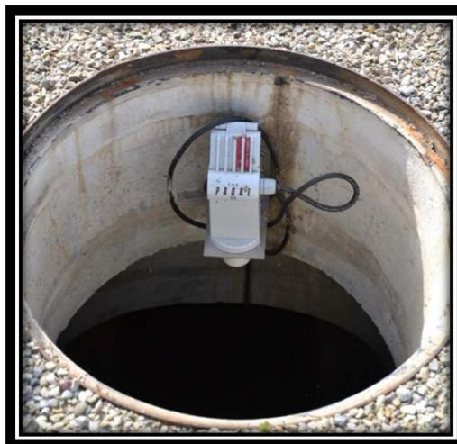
Sonde à ultrason à l'amont de la mare de sédimentation
