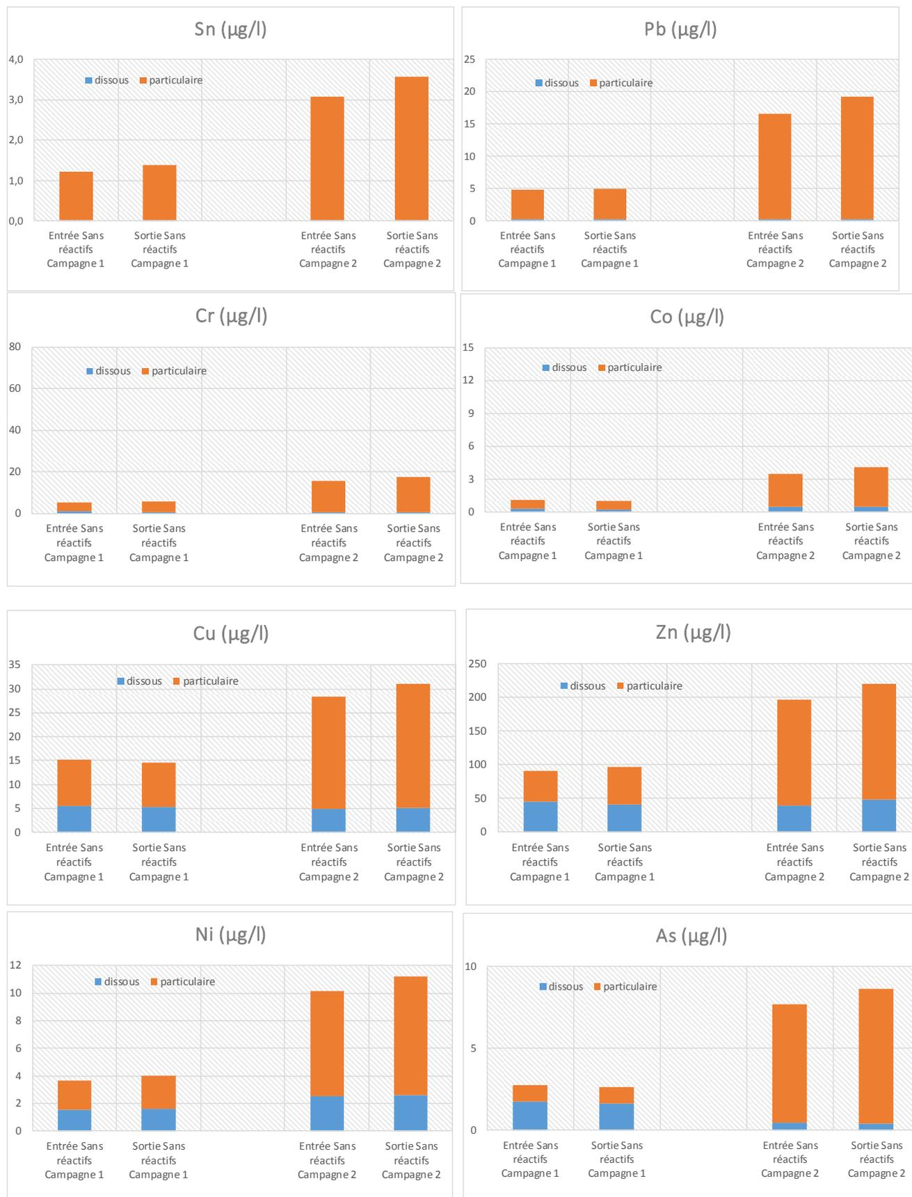
**Figure 35 : Concentrations en éléments traces métalliques entrée et sortie du pilote fonctionnant sans réactifs**
