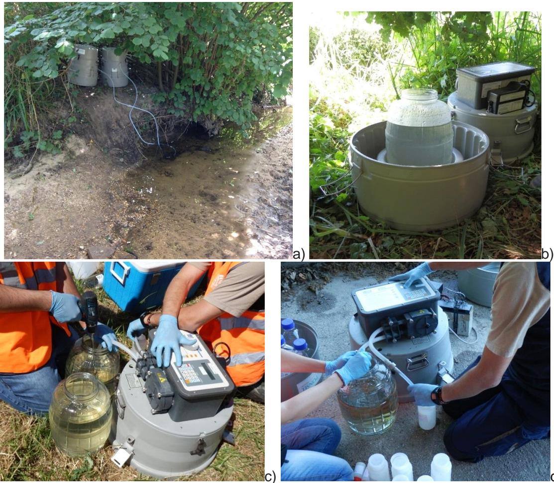
**Figure 51** Prélèvements d'eau dans le milieu naturel sur 24h à l'aide de préleveurs automatiques (a), dans une unique bombonne en verre (b) puis homogénéisation à l'aide d'une perceuse (c) et répartition dans les flacons des différents laboratoires d'analyses (d).
