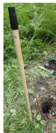
Figure 73 Manche en bois permettant de signaler les sondages.
