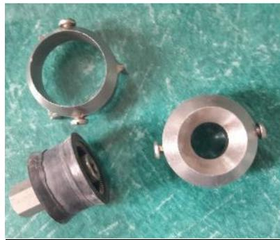
**Figure 77** Les différents embouts du carottier : en haut, l'embout pour sédiments durs ; à droite, l'embout pour sédiments vaseux ; en bas à gauche, le joint sur lequel on fixe la tige en métal qui sert de piston.
