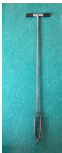
Figure 72 Tarière utilisée pour les sondages et les prélèvements de sol.
