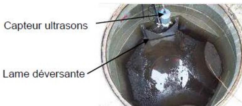
**Figure 60** Installation des équipements de mesure de débit au point de mesure aval des noues de Vert-Castel.
