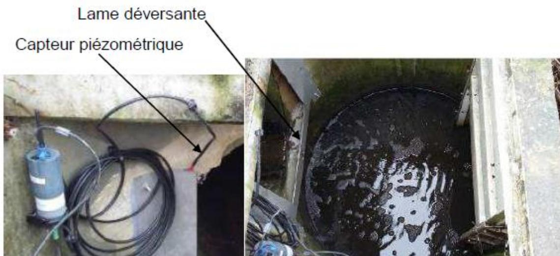
**Figure 57** Installation du débitmètre au point de mesure aval du bassin de dépollution.
