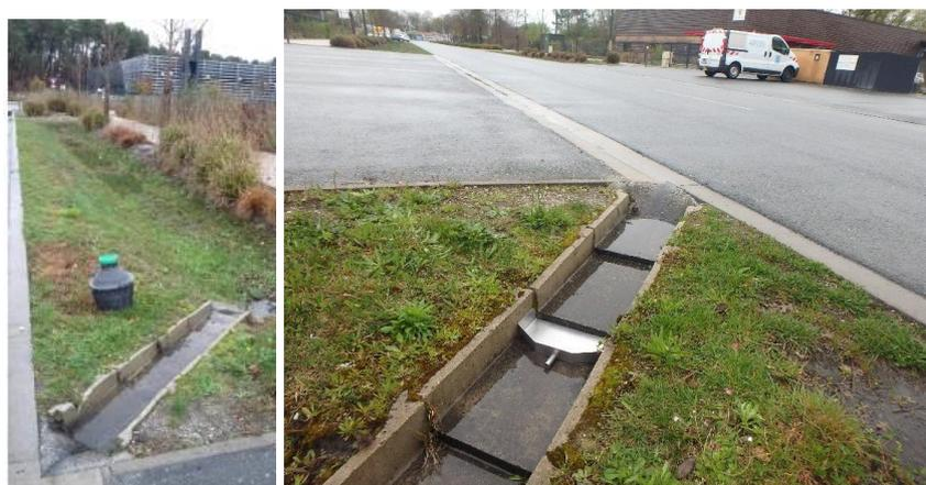
**Figure 59** Prélèvement d'eau en amont de la noue à l'aide d'une bombonne en verre et d'un système de collecte en inox.
