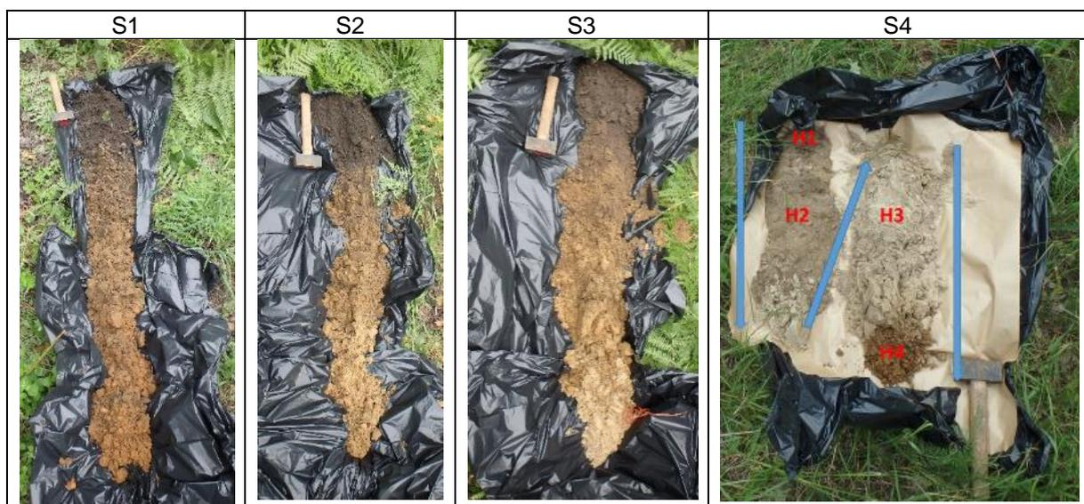
**Figure 75** Les différents horizons visibles dans les 4 points de sondage.
