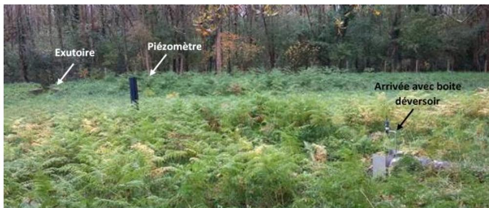
Figure 54 Instrumentation du bassin d'infiltration du Bois de Germignan.
