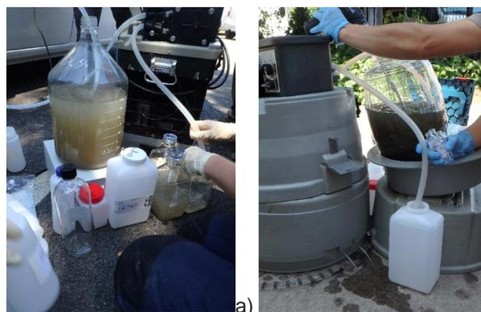
**Figure 67** Photos illustrant la répartition d'un échantillon d'eau usée entre les flacons des différents laboratoires d'analyses. L'échantillon est homogénéisé pendant toute la durée de la répartition à l'aide d'un agitateur magnétique et d'un barreau aimanté (a) ou à l'aide d'une pôle métallique fixée à une perceuse/visseuse actionnée manuellement (b)
