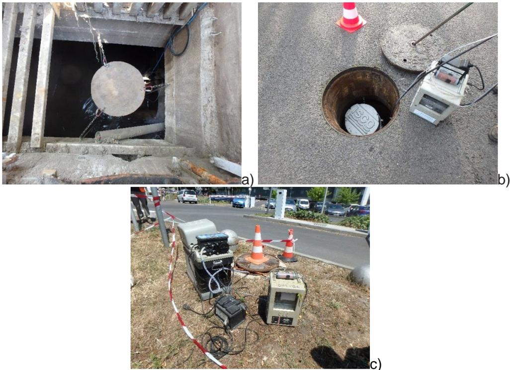
**Figure 66** Photos illustrant les 2 façons d'installer un préleveur automatique pour réaliser les prélèvements d'eaux usées. 1er cas : quand le point de prélèvement est sur la chaussée par exemple utilisation d'un plateau de soutien (a) et préleveur caché dans le regard (b) ou 2<sup>ème</sup> cas : préleveur laissé à l'extérieur avec une zone de balisage (c)
