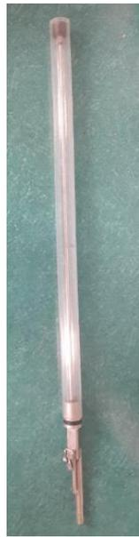
**Figure 76** Carottier utilisé pour les prélèvements de dépôts sédimentaires.
