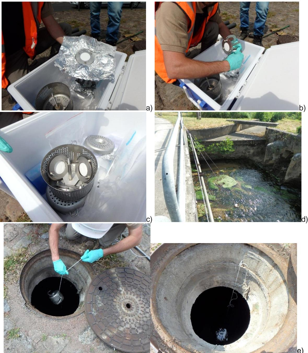
**Figure 80** Exposition des POCIS : un POCIS (a), fixation du POCIS sur le support (b), positionnement du support dans la cage de protection (c), exposition en milieu naturel (d), exposition dans le réseau d'assainissement (e).
