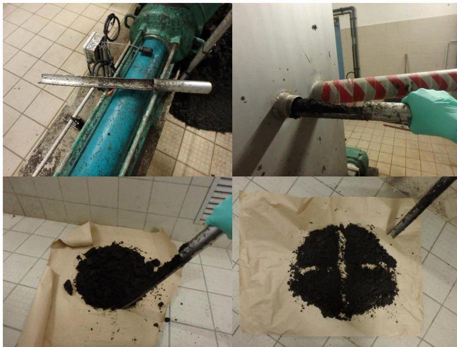
**Figure 69** Photos illustrant un prélèvement de boue solide.
