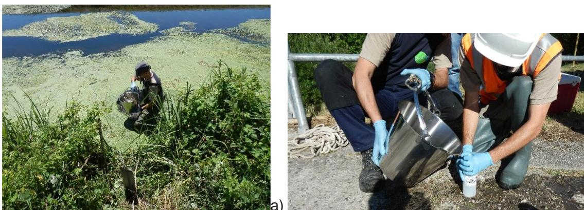
**Figure 52** Prélèvement d'eau manuel dans le milieu naturel à l'aide d'un seau en inox (a) puis répartition dans les flacons des différents laboratoires d'analyses (b).
