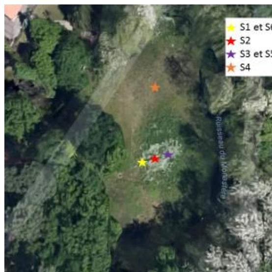
Figure 39 - Positionnement des sondages dans le bassin d'infiltration
