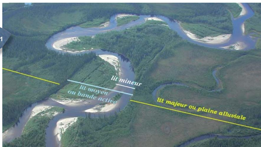
Les lits mineur, moyen et majeur dans l'hydrosystème fluvial (le Yukon, Alaska, source : USGS. Tous droits réservés). Noter les bras morts au sein de la plaine alluviale, qui peuvent véhiculer une partie des débits de crue.
