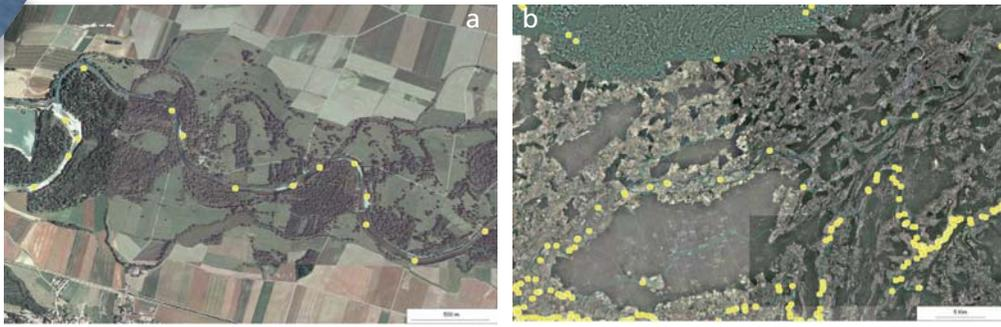
Franche-Comté. Exemples de localisation et de cartographie simplifiée sous SIG des bancs alluviaux visibles (in Malavoi et al., 2006). Chaque banc alluvial est simplement représenté par un point.
