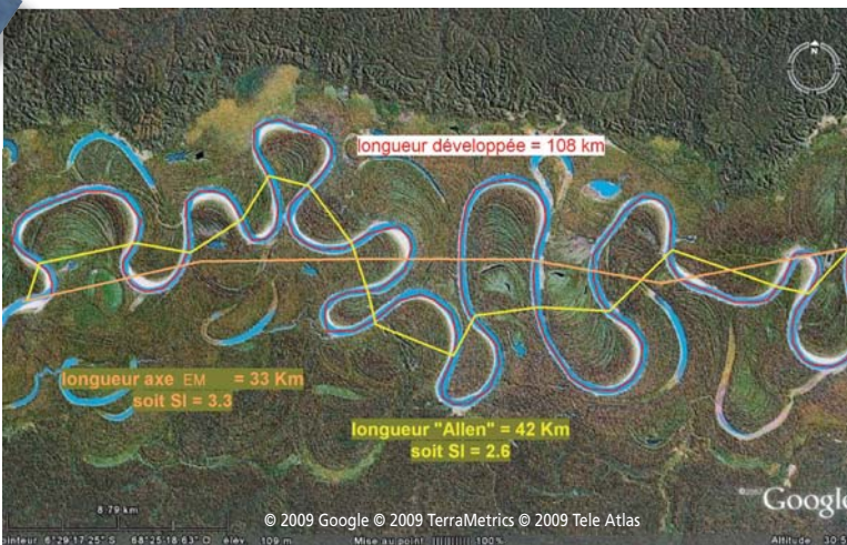
Exemple de fort coefficient de sinuosité sur un cours d'eau du bassin amazonien.
