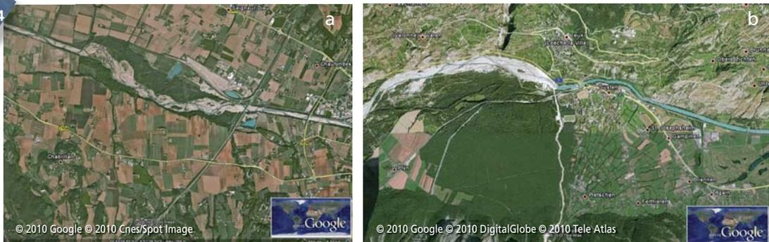
(a) Disparition du tressage sous l'effet d'un endiguement étroit (la Drôme aval); (b) réapparition brutale du tressage à la fin d'une portion chenalisée (Rhône amont en Suisse). Sur les deux photos l'écoulement se fait de droite à gauche.
