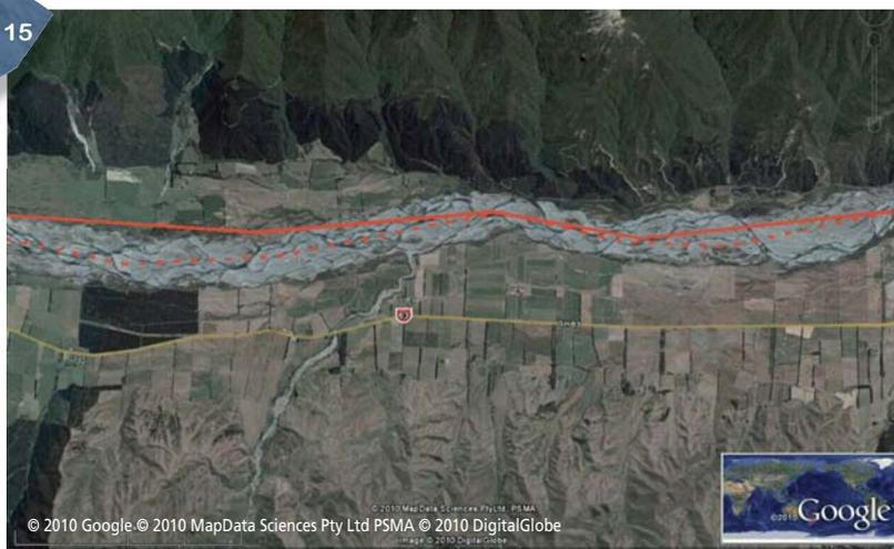
Coefficient de sinuosité de la bande active : 1,01 (Nouvelle-Zélande).
