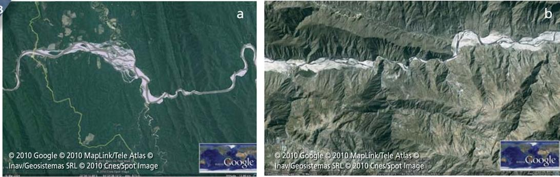
(a) Apparition d'un tressage local au droit d'un élargissement de la vallée et inversement, (b) disparition d'un tressage généralisé sous l'effet d'un rétrécissement ponctuel. On comprend ici le rôle essentiel de la largeur du fond de vallée comme variable de contrôle des processus géodynamiques et des morphologies qui en résultent (est des Andes, Bolivie).
