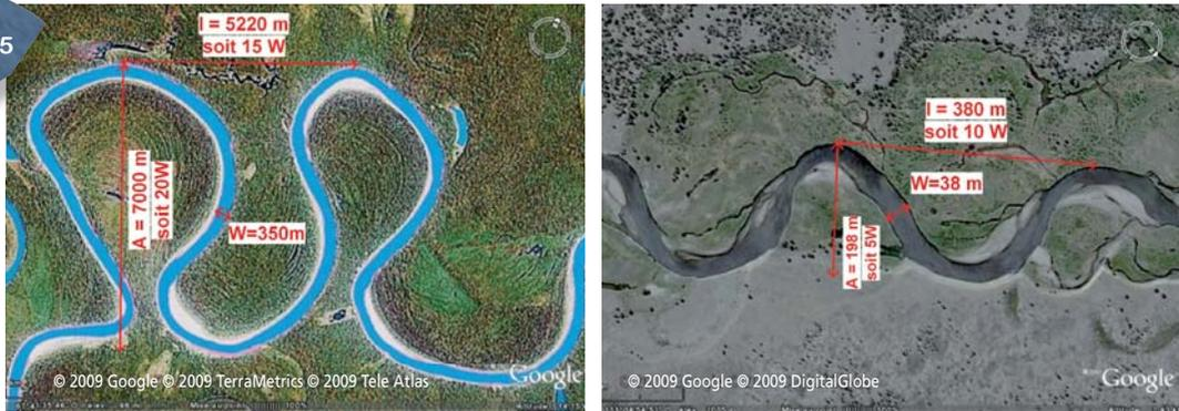
Exemples de calculs d'amplitude et de longueur d'onde (le coefficient de sinuosité est de 3,5 sur la photo de gauche et de 1,38 sur la photo de droite).
