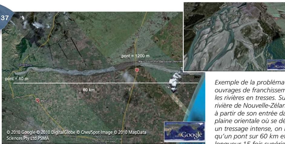
*Exemple de la problématique des ouvrages de franchissement sur les rivières en tresses. Sur cette rivière de Nouvelle-Zélande, à partir de son entrée dans la plaine orientale où se développe un tressage intense, on ne trouve qu'un pont sur 60 km et d'une longueur 15 fois supérieure à celle du dernier pont en amont !*
