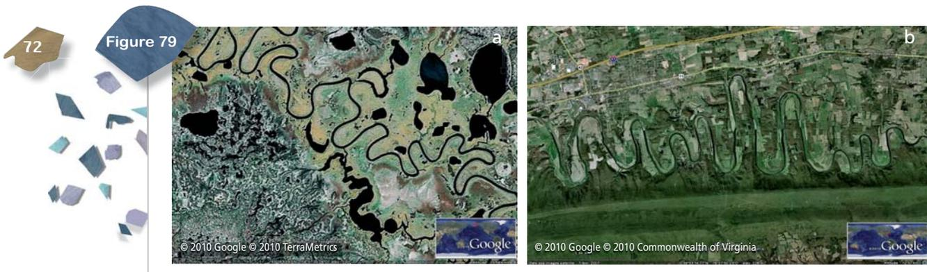
(a) Méandres très tortueux (Alaska, USA). Calculer une longueur d'onde ou un rayon de courbure moyen devient difficile... (b) Méandres de la Shenandoah (Appalaches, USA), influencés par le cadre structural. Non, l'image n'est pas déformée... sinuosité 3,9 ; amplitude maximale 48W !
