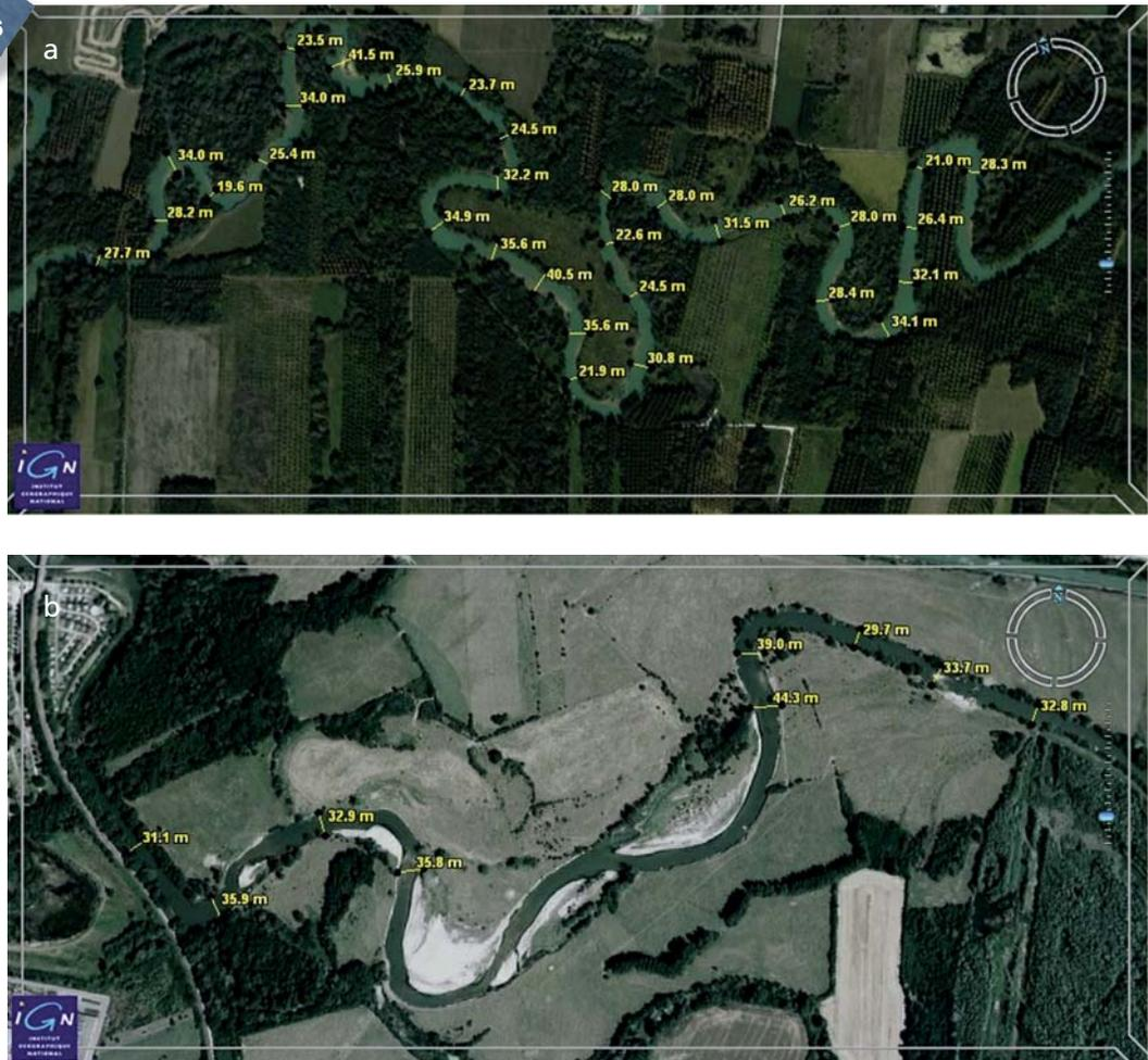
Il est recommandé de mesurer les largeurs à pleins bords dans des portions rectilignes ou au droit de points d'inflexion. Si cela a une moindre importance sur les rivières peu actives (a) sur lesquelles on peut réaliser des mesures systématiques, cela devient important dans les zones où la dynamique d'érosion/dépôt peut être localement forte et où les sur-largeurs au niveau des sinuosités actives peuvent être importantes et non significatives si elles sont peu nombreuses sur le tronçon (b).
