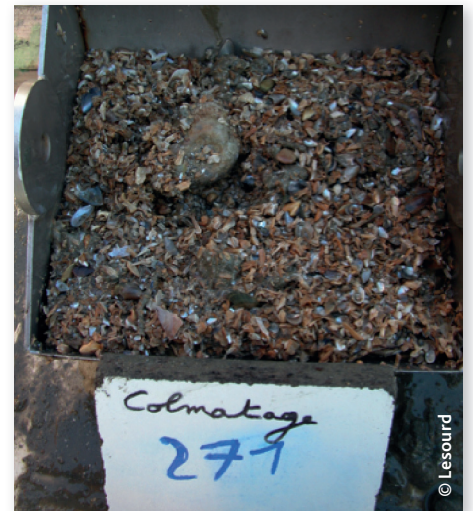
FIGURE 25 Benne de prélèvement sédimentaire contenant du sable bioclastique
