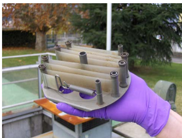
Figure 23 : Photo d'un SPMD sur un support d'exposition in situ
