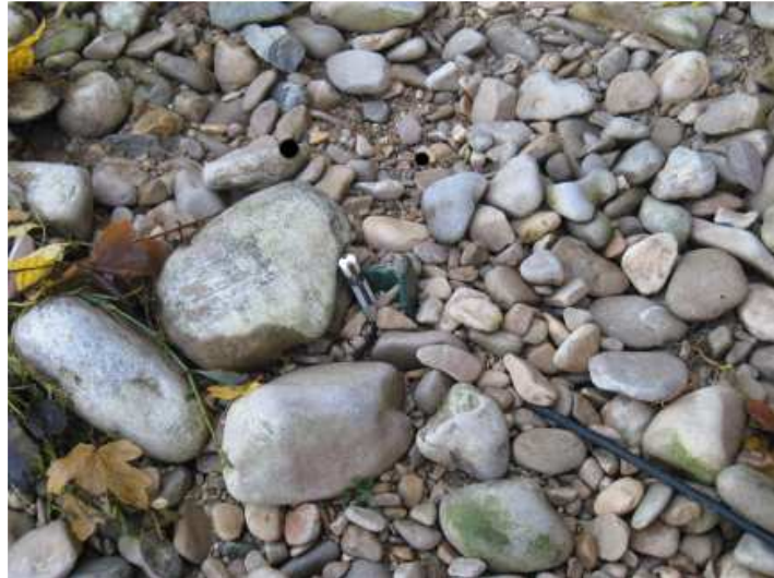
Figure 10 : position de la sonde in situ . En fait, la sonde doit affleurer le sédiment mais elle est ici positionnée plus haut que le piquet, contrairement à l'usage, afin qu'on la distingue mieux sur la photo
