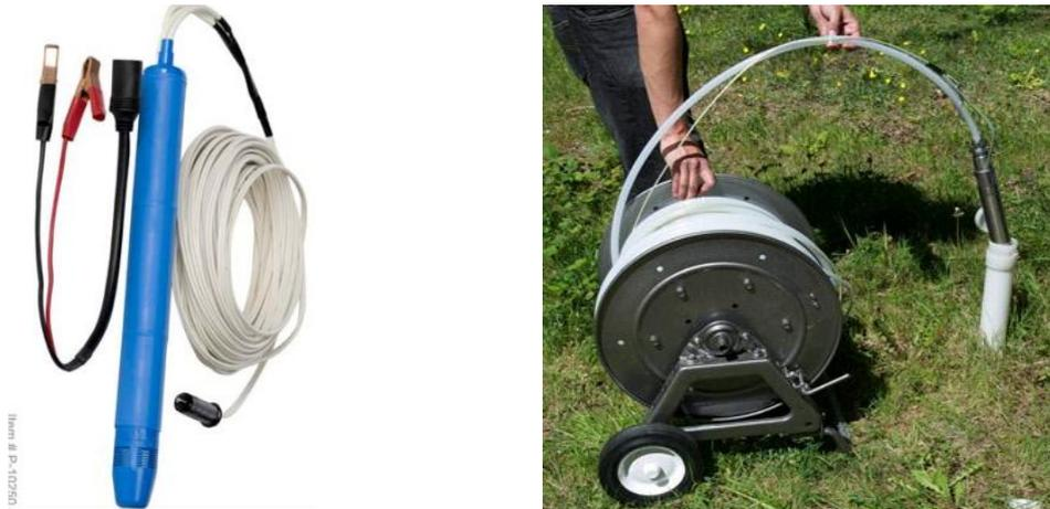
illustration 26 :Pompes Twister et Grundfos MP1 utilisées pour la campagne de prélèvement
