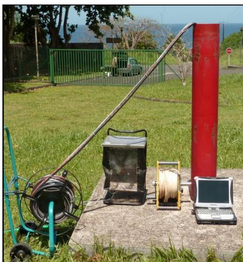
*illustration 25 :Matériel utilisé lors des prélèvements*
