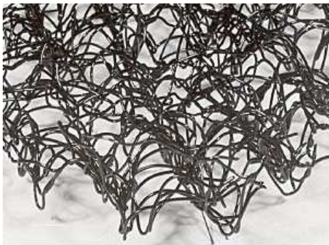
Figure 23 : Exemple de géogridde tridimensionnelle commercialisée par ENKAMAT®
