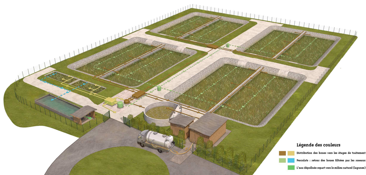
Figure 19 : Schéma fonctionnel de l'unité de traitement des matières de vidange de Nègrepellisse (82, 11 000 m 3 /an). Schéma Epur nature.
