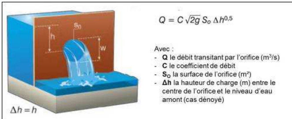
Figure 11 : Formule pour le calcul du débit transitant par un orifice dénoyé (figure adaptée de Le Coz et al. 2011).
