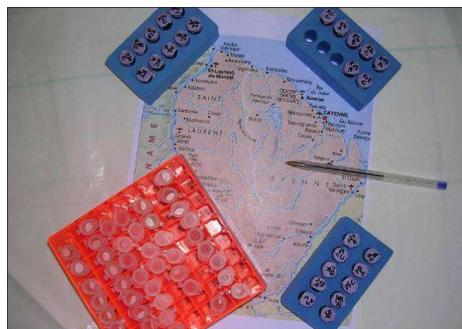
**Figure 28.** Echantillons DGT et SBSE (10 stations) prêts pour l'analyse après conditionnement sur place lors de la campagne de 2010 en Guyane (Source : Gonzalez *et al.*, 2012c).
