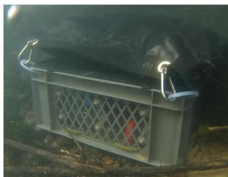
Figure 6 : Système d'immersion contenant les cages de gammars
