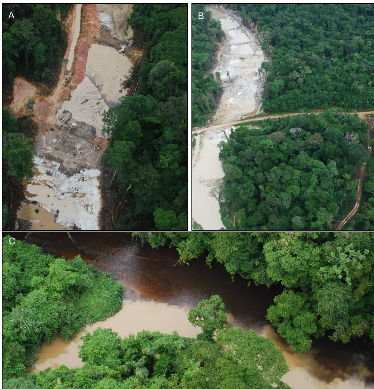
Figure 17 : Impacts directs et indirects de l'activité d'orpaillage avec A. Destruction du lit du cours d'eau et du corridor riverain ; B. Mise en place des voies de communication pour l'accès au site ; C. Panache turbide liée à l'activité minière sur un site à l'amont (DEAL Guyane)
