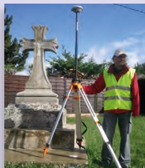
**Photo 2.** Mesure GPS sur trépied.
