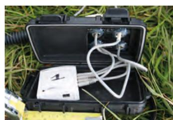
**Photo 7.** Sonde hyporhéique à quatre capteurs verticaux de température connectés à leur datalogger.
