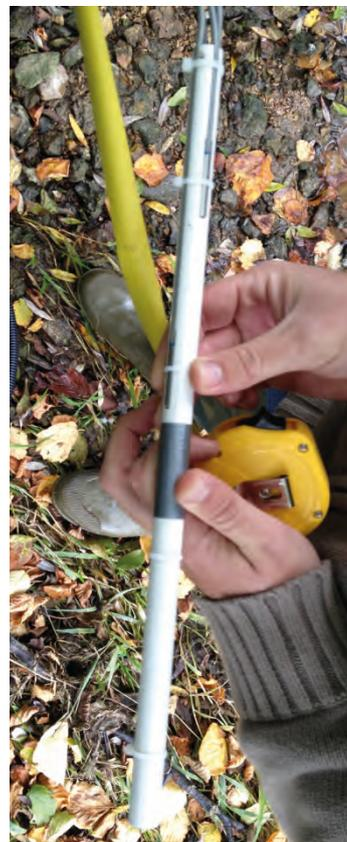
**Photo 6.** Sonde hyporhéique à quatre capteurs verticaux de température.
