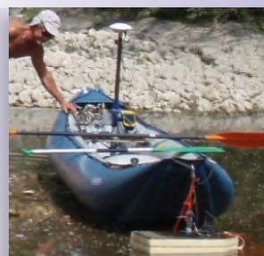
Photo 1. GPS monté sur canoë.
