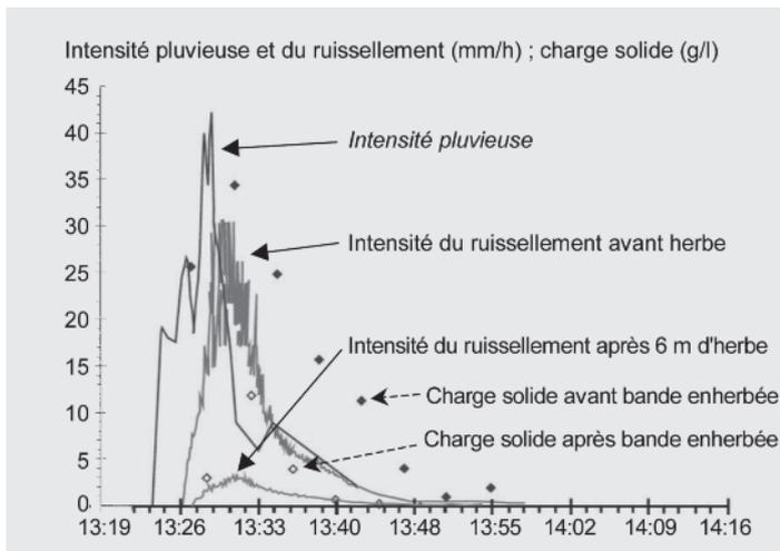
FIGURE 4 : Comparaison des hydrogrammes d'entrée et de sortie pour le ruissellement et les matières en suspension sur une bande enherbée de 6 m lors d'un événement pluvieux (LECOMTE, 1999).
