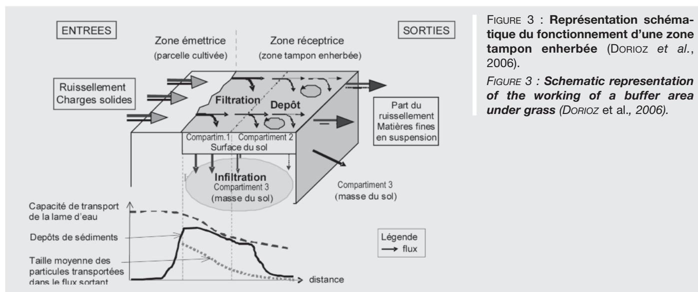
FIGURE 3 : Représentation schématique du fonctionnement d'une zone tampon enherbée (DORIOZ et al., 2006).
