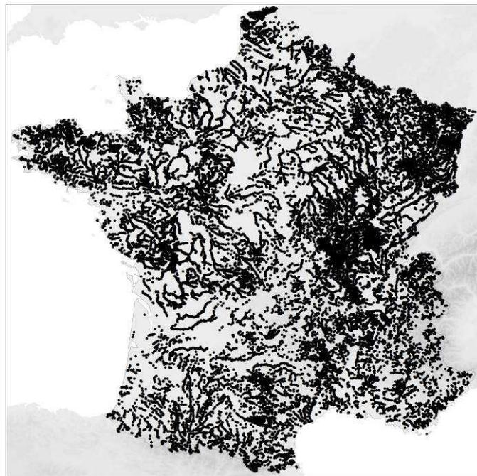
**Fig. 2.2.6** Position de l'ensemble des obstacles à l'écoulement de type barrage ou seuil recensés par la base de données ROE (ONEMA - mars 2011)
