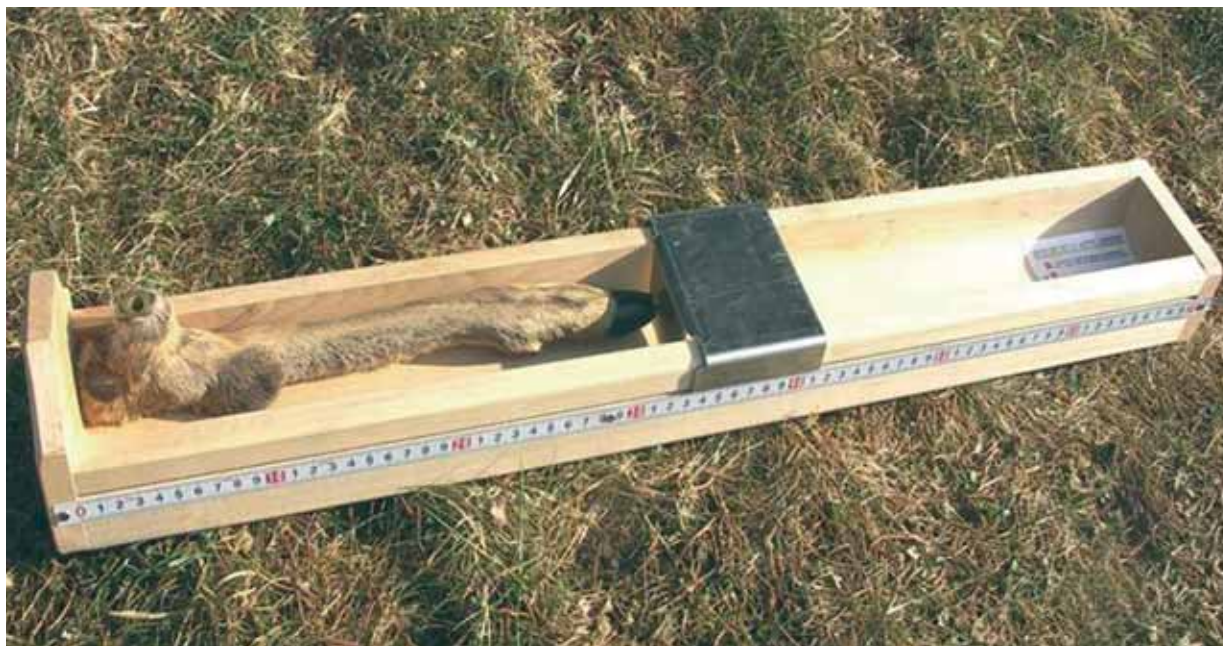
Le « Guyapon » : un appareil simple et efficace pour mesurer précisément la longueur de la patte arrière des ongulés.
