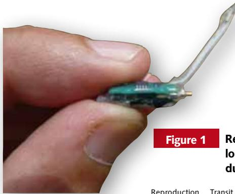
Un GLS Mk14 du BAS utilisé pour cette étude. Le capteur de luminosité est situé sur un pédoncule pour le maintenir hors du plumage.
