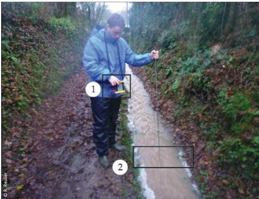
▲ Mesure des débits au moulinet.
