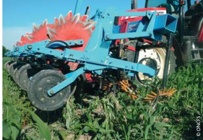
▲ Désherbage mécanique avec une bineuse à doigts Kress sur un assec cultivé en maïs.
