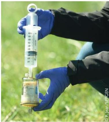
▲ Filtration de l'eau par écoulement dans une capsule équipée d'une membrane de faible porosité.
