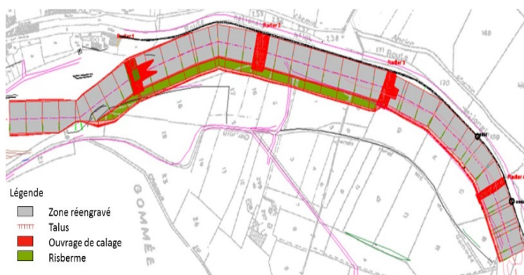
Plan des travaux réalisés sur le tronçon de l'Ouvèze à Rompon - ©Communauté d'Agglomération Privas Centre Ardèche
