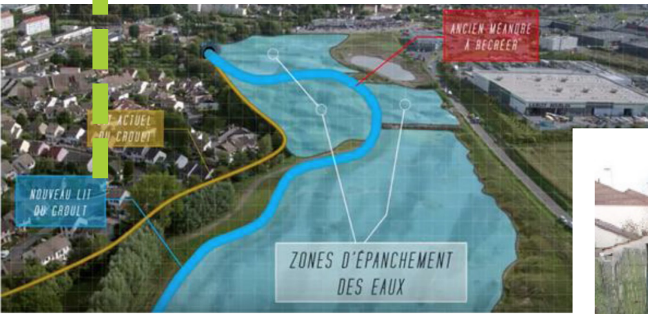
Le cours d'eau restauré et sa zone d'expansion de crue.
