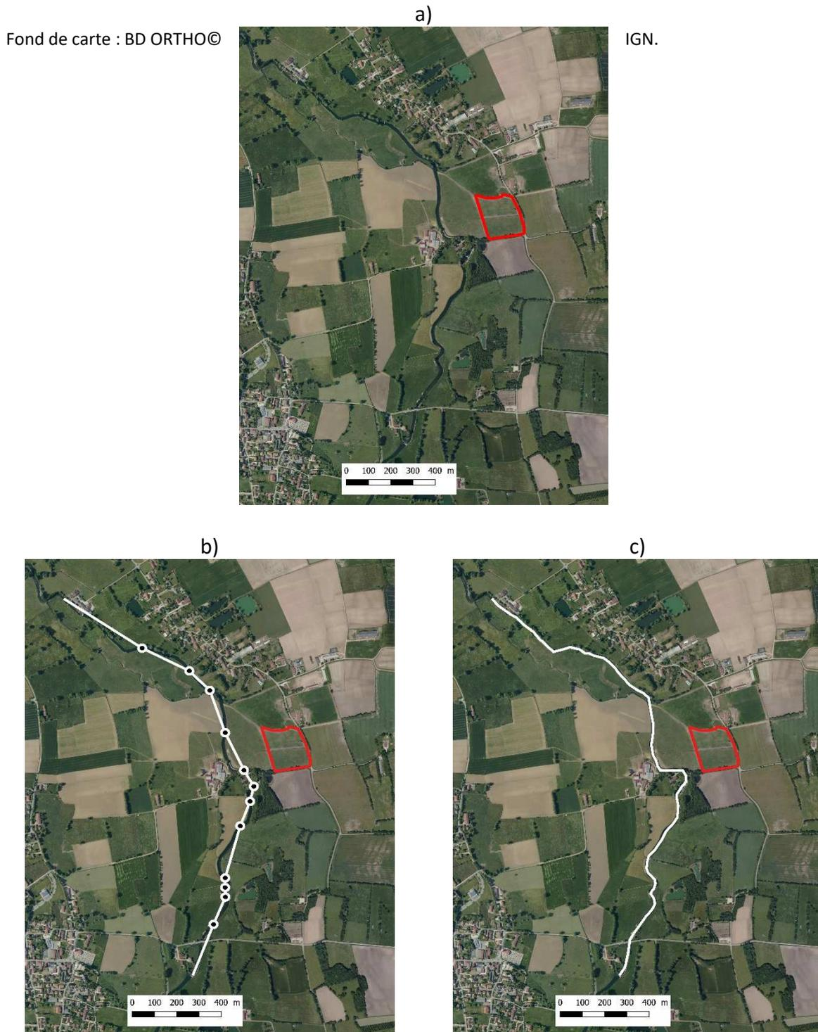
**Figure 2 :** Illustration d'un site (polygone au contour rouge sans trame de fond) dans un système hydrogéomorphologique alluvial (a), de la longueur de l'enveloppe de méandrage (trait blanc) en passant par les points d'inflexion des sinuosités du cours d'eau (points au contour blanc) (b) et de la longueur développée du cours d'eau (trait blanc) (c) mesurées conformément aux indications données dans la question 43.
