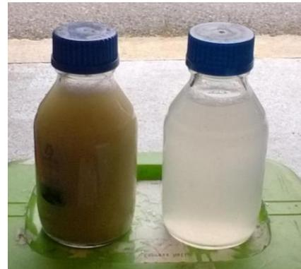
Figure 12 : Photographie de l'échantillon amont à gauche et aval à droite chez le premier peintre. Source: CNIDEP
