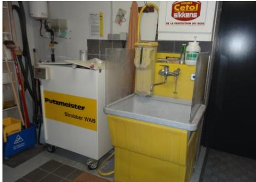
Figure 27 : Photo de la machine de nettoyage des outils Putzmeister Strober WA et WAB800 installée dans l'entreprise de peinture n°3.
