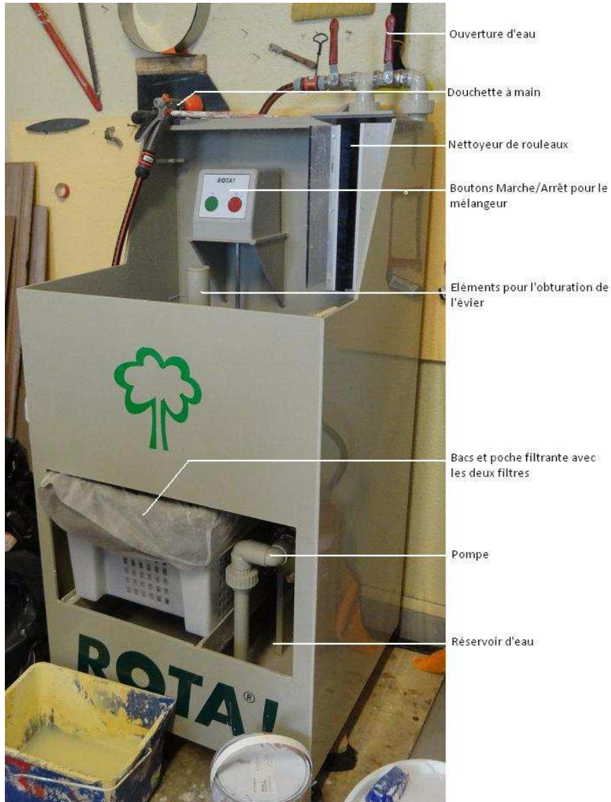
Figure 22 : Photo de la machine de nettoyage des outils Rotaclean WWA50 de Rotaplast installée dans l'entreprise de peinture n°2 et identification des différents éléments. Source : CNIDEP
