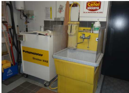
Figure 27 : Photo de la machine de nettoyage des outils Putzmeister Strober WA et WAB800 installée dans l'entreprise de peinture n°3. Source : CNIDEP
