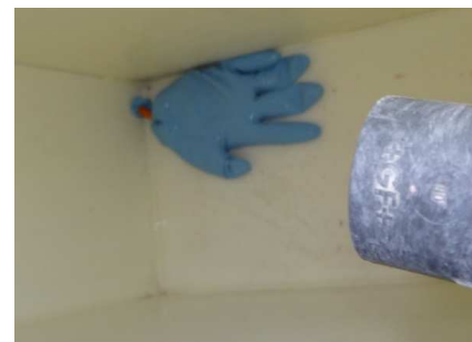
Figure 30: Installation mise en place pour prélèvement aval dans l'entreprise 3. Source : CNIDEP
