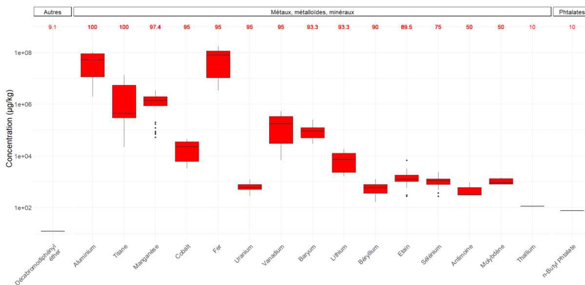
Figure 24. Concentrations des métaux, métalloïdes et minéraux dans le sédiment à l'échelle des DROM
