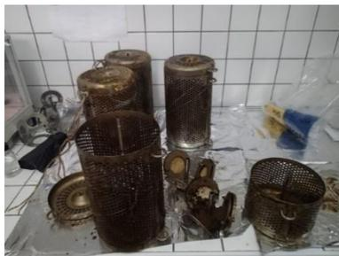
**Figure 5** : Ouverture des cages au laboratoire et récupération des POCIS
