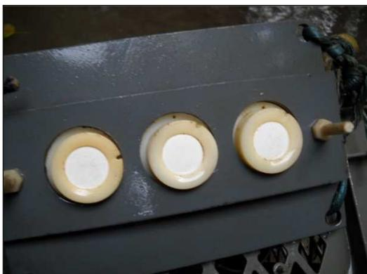
**Figure 2: Photo du système d'exposition des DGT d'INRAE.**
