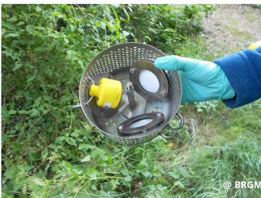
**Figure 3: Photos du système d'exposition des POCIS du BRGM, un canister inox Exposmeter.**
