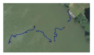
Exemple de positionnement : données brutes non corrigées, en sortie de l'algorithme de calage de la centrale inertielle
