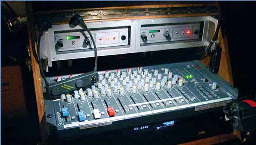
Dispositif d'audiodescription : régie, table de mixage, radiateur infrarouge et casque récepteur sans fil. CI. Association Accès Culture
