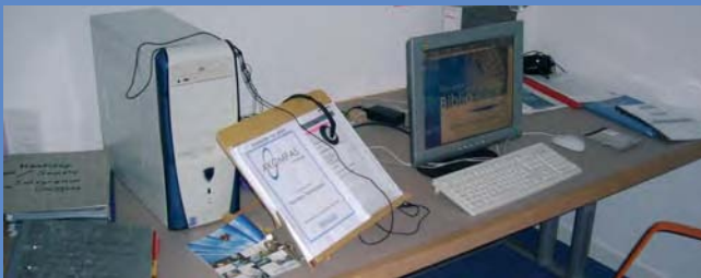
Machine à lire permettant la lecture en synthèse vocale de tous documents imprimés grâce à un scanner et à un logiciel de synthèse vocale incorporé. Cet outil est disponible dans l'espace « Lire autrement » de la bibliothèque de l'Alcazar à Marseille. © BMVR/Ville de Marseille
