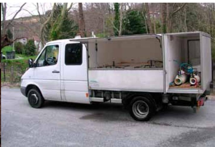
Caisses de transport et camion vivier muni d'un système d'oxygénation
