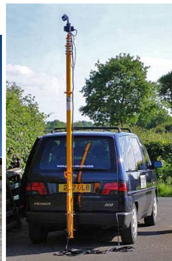
Figure 2 : exemples de petit ballon ou de mât télescopique (jusqu'à 15 m pour ce modèle) permettant de réaliser des photos à basse ou très basse altitude.
