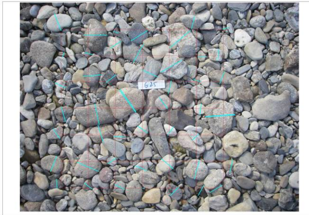
Figure 16 : le substrat correspondant à cette photo (mesure sous SIG de 49 éléments échantillonnés sur une grille virtuelle à mailles carrées, après mise à l'échelle de la photo) serait codé visuellement - PGPFCG -
