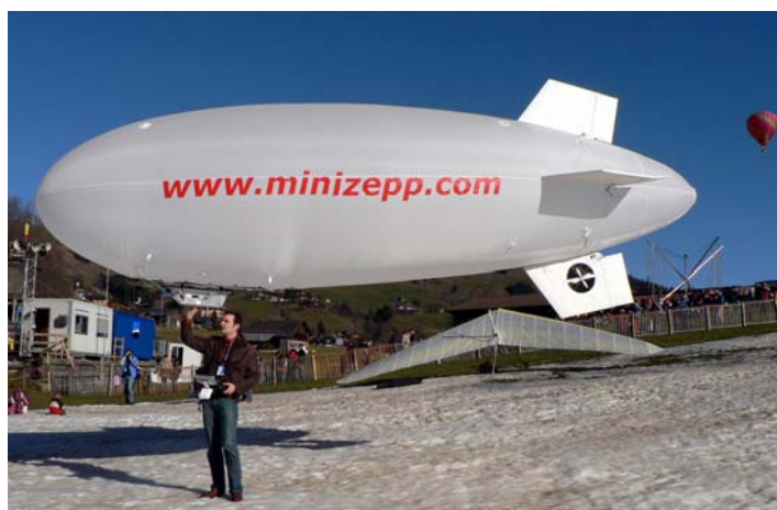
Figure 2 : exemples de petit ballon ou de mât télescopique (jusqu'à 15 m pour ce modèle) permettant de réaliser des photos à basse ou très basse altitude.
