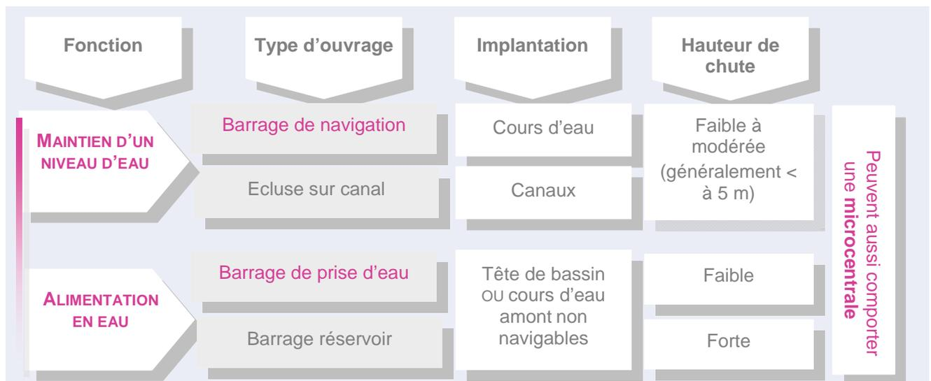
Figure 3: Typologie simplifiée des ouvrages VNF
