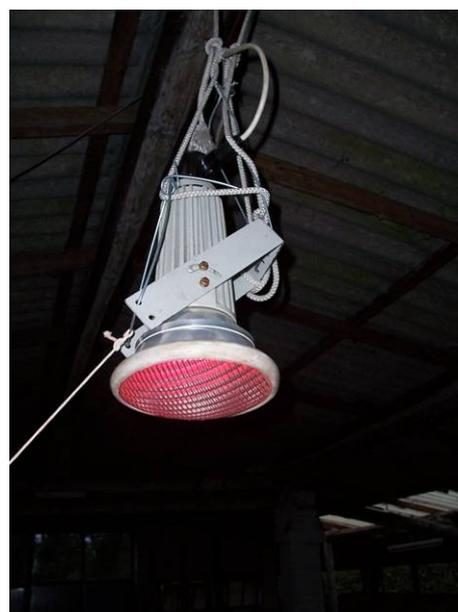
Figure 30. Photo d'un projecteur infrarouge
