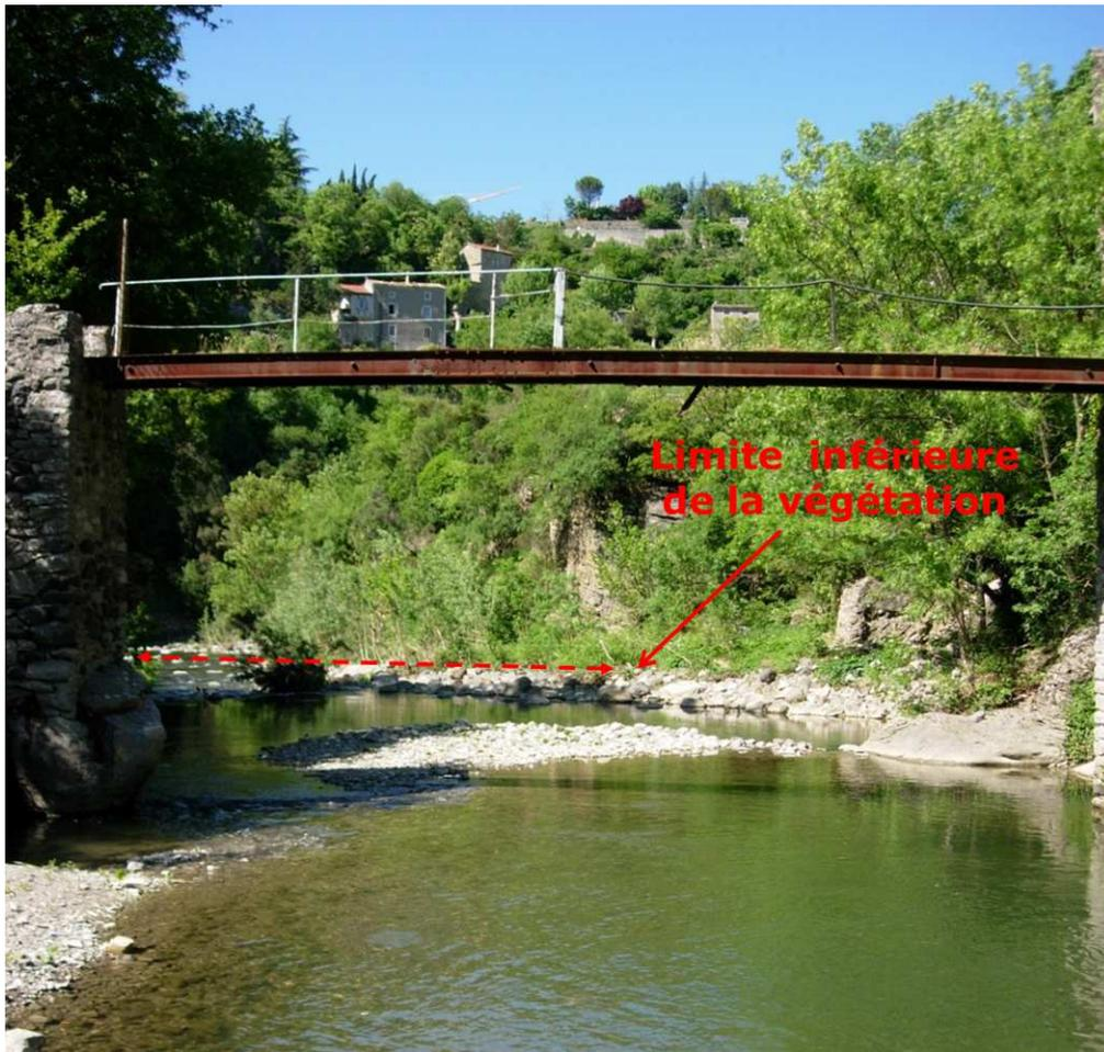
**Figure 8 : Illustrations de la mesure de la géométrie à pleins bords en situation complexe**
