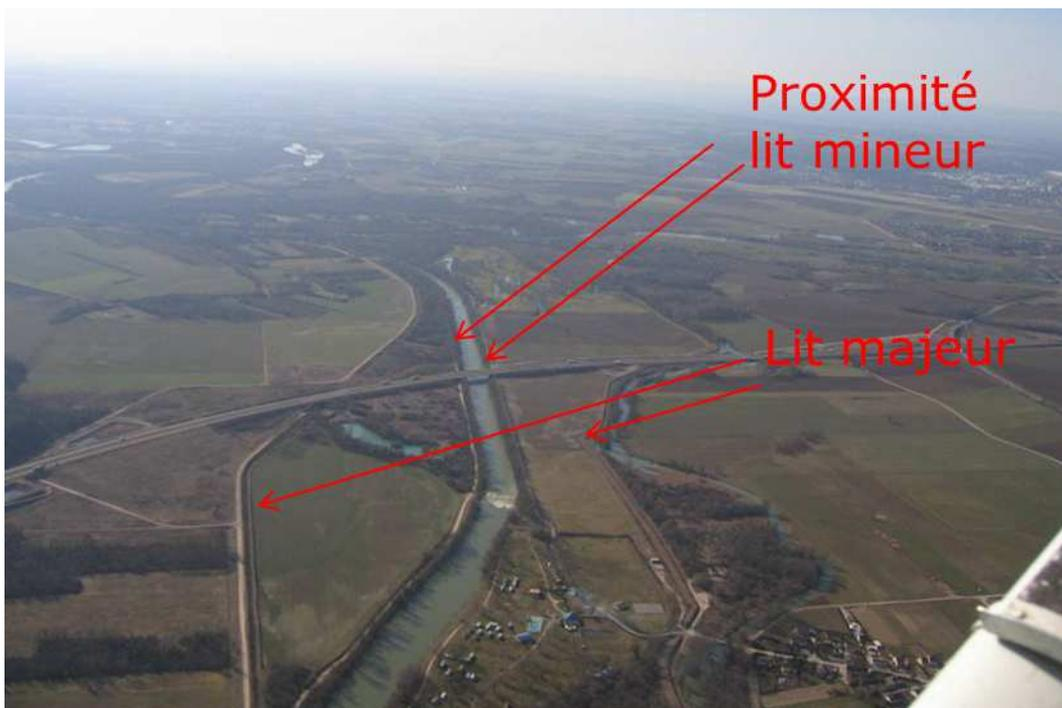
**Figure 11 : Double endiguement en béton (lit mineur et lit majeur)**
